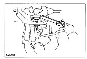
INSTALLATION OF BALL JOINTS 1. INSTALL UPPER BALL JOINT TO UPPER SUSPENSION ARM
