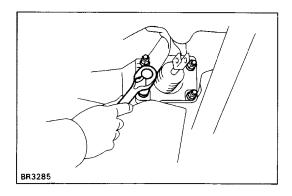
5. REMOVE BRAKE BOOSTER, GASKET AND CLEVIS
