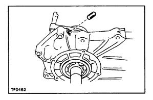
(d) Using a magnetic finger, remove the straight pin.
