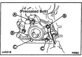
(d) Torque the relief valve plug.
