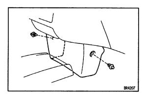
(d) Install the instrument lower center cover and 2 clips.
