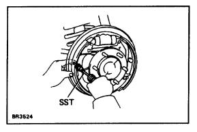
(d) Using SST, connect the return spring. SST 09703–30010
