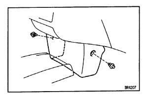
(d) Install the instrument lower center cover and 2 clips.
