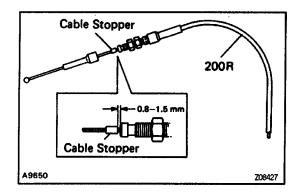
5. IF THROTTLE CABLE IS NEW, STAKE STOPPER ON INNER CABLE
