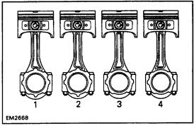
(d) Arrange the piston and connecting rod caps in order.
